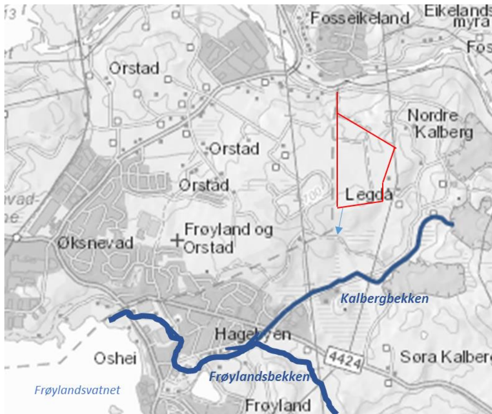
Figur 6. Planområdets sørlige del drenerer mot Kalbergbekken som renner ut i Frøylandsbekken. Hovedsakelig avrenningsvei fra planområdet er vist med blå pil.
